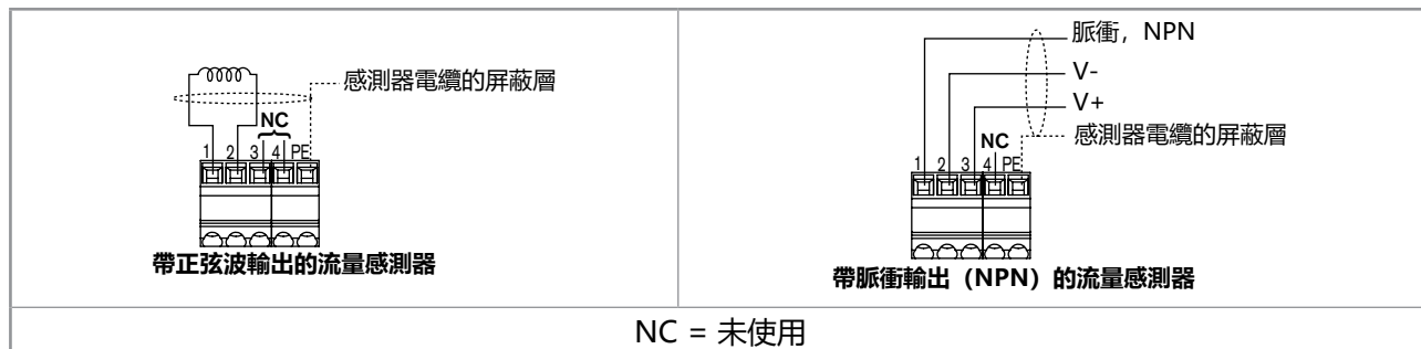
圖 53: 將遠端流量感測器連接到 8025 流量計
