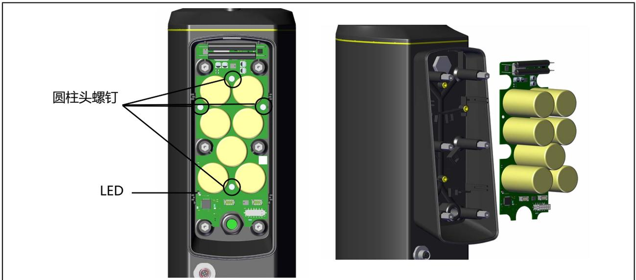
图 13: 松开电路板上的螺钉/取出 SAFEPOS energy-pack
