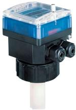
如果設備與管路中的一個或兩個閥門串聯安裝，8025 型計量設備則可以計量一種或多種液體量。該設備控制閥門打開並計算流過的液體量。一旦達到預設量，設備就會關閉閥門。
