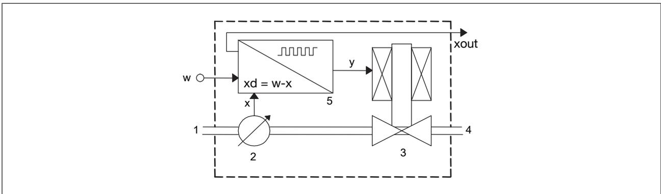
图 14: 带调节阀的 MFC 功能图
