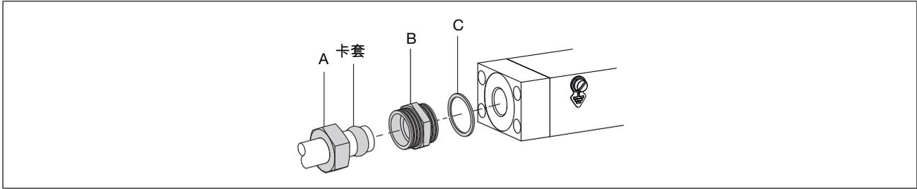
图 7: 管道上的螺母和卡套
