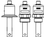
1.) 标称电极常数。每个产品都是根据 Bürkert 的内部规范得到测量的。各个电极常数可在产品随附的校准记录中找到。电极常数会受到安装环境的影响。
