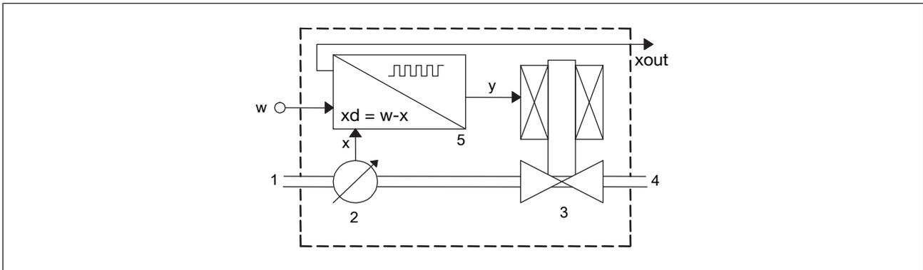
图 14: 带调节阀的 MFC 功能图
