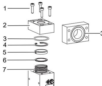
图 15: 接触介质的部件
