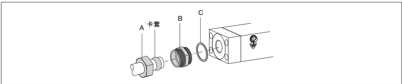
图 7: 管道上的螺母和卡套
