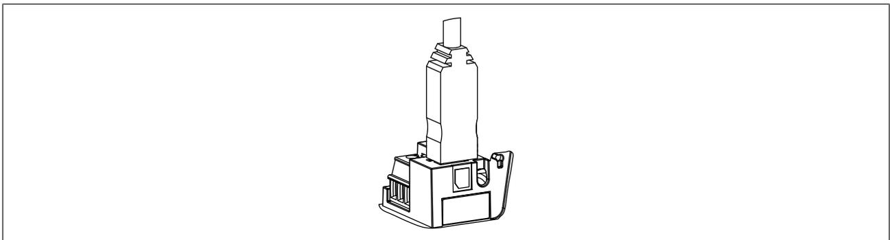
图 5: büS 驱动盘，插入设备的相应接口
