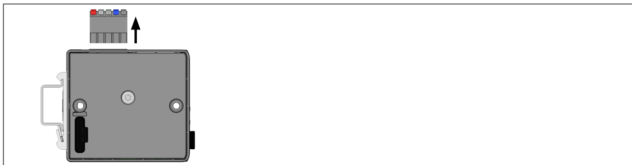
图35: 移除 5 针弹簧端子
