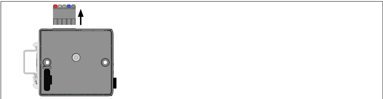
图31: 移除 5 针弹簧端子
