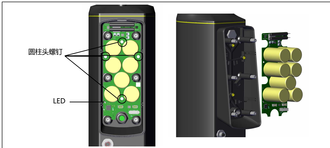
图 12: 松开电路板上的螺钉/取出 SAFEPOS energy-pack
