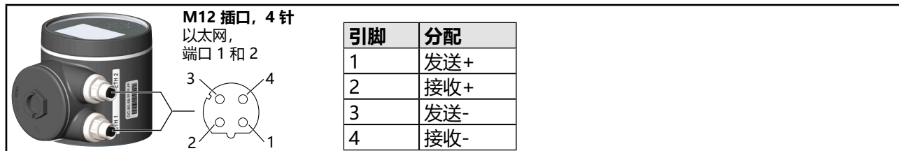
图 31: 现场总线网关的电气连接和分配
